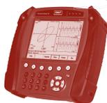
Анализаторы Microlog являются полноценной портативной системой анализа вибрации, в комплекте с которой поставляется специализированное программное обеспечение SKF, позволяющее обеспечивать быстрое, эффективное и надежное хранение, обработку и получение большого объема комплексной информации по отдельным единицам оборудования и системам.
