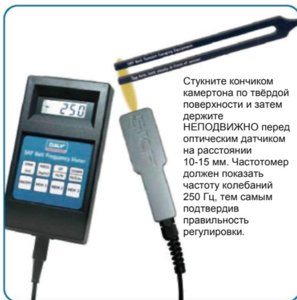
Стукните кончиком камертона по твёрдой поверхности и затем держите **НЕПОДВИЖНО** перед оптическим датчиком на расстоянии 10-15 мм. Частотомер должен показать частоту колебаний 250 Гц, тем самым подтвердив правильность регулировки.
