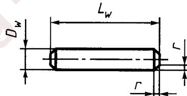
$D_w$  — номинальный диаметр ролика;  $L_w$  — номинальная длина ролика;  $R$  — номинальный радиус сферы торца ролика;  $r$  — номинальная координата фаски ролика с плоским торцом.
