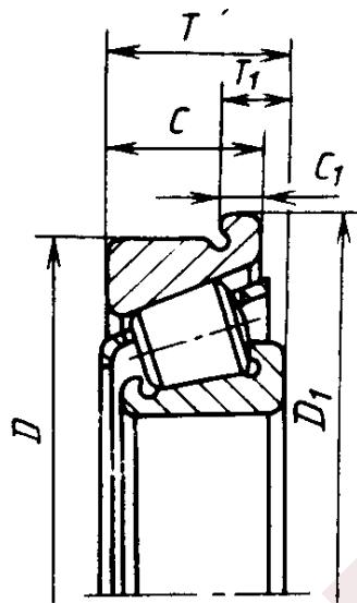
$D_1$  – номинальный диаметр упорного борта;  $C_1$  – номинальная ширина упорного борта;  $T_1$  – номинальная монтажная высота упорного борта;  $D$  – номинальный диаметр наружной цилиндрической поверхности наружного кольца;  $C$  – номинальная ширина наружного кольца;  $T$  – номинальная монтажная высота подшипника
